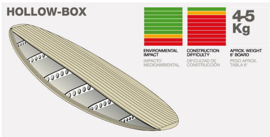
Figura 5. Sistema de fabricación hollow-box de Flama Surf
