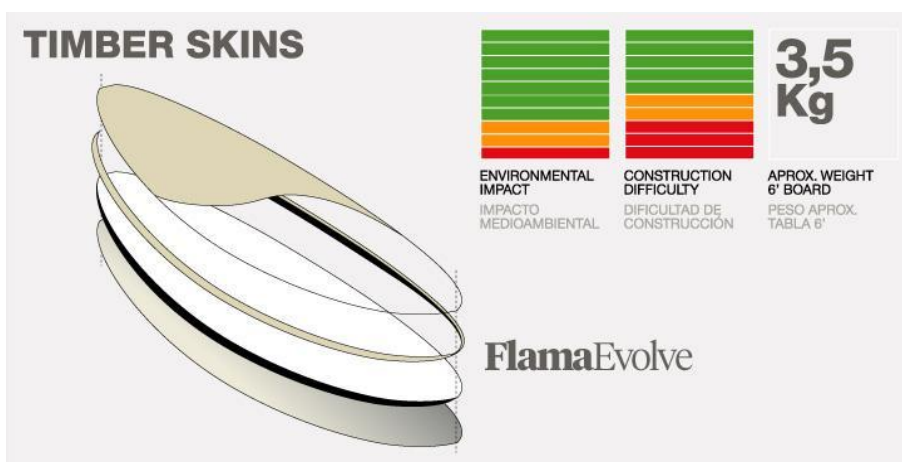
Figura 6. Sistema de fabricación timber skins de Flama Surf
