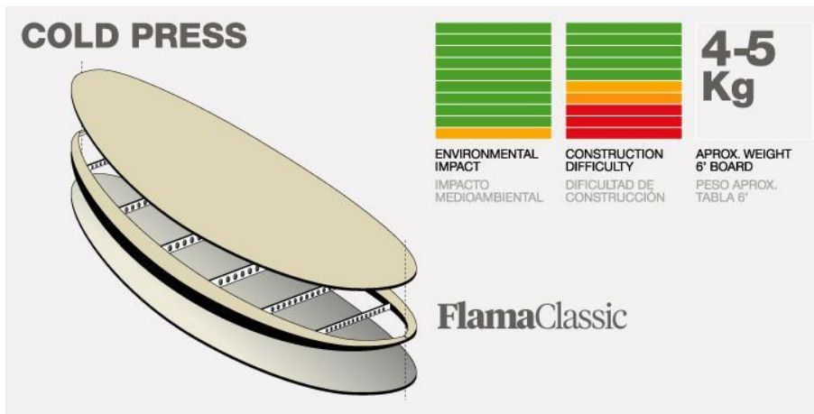
Figura 4. Sistema de fabricación cold press de Flama Surf
