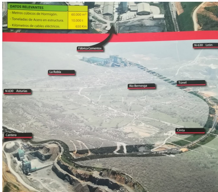
Figura 6. Recorrido de la cinta desde la cantera hasta la fábrica.
