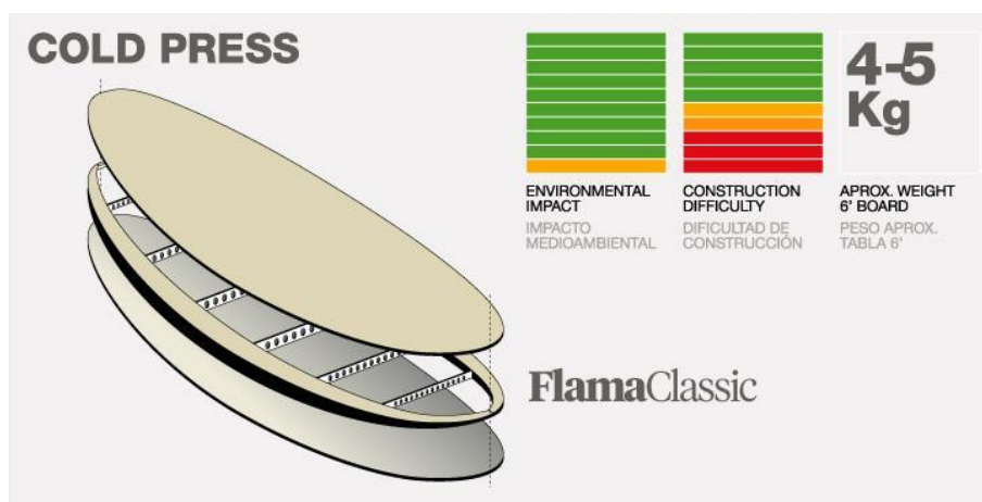
Figura 4. Sistema de fabricación cold press de Flama Surf
